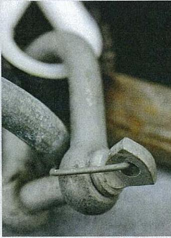
**KAUSER OG SJAKLER:** Bruk kauser og sjakler der du fester fortøyningstauene på brygge/utriger. Egentlig er det best å bruke galvanisert mot galvanisert og rustfritt mot rustfritt. Kontroller at tauene er i god stand, uten skader.
